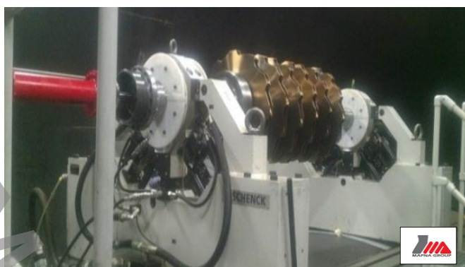
شکل ۵: الف: چیدمان آزمون روتور کمپرسور ب: نتایج تجربی ۱۹ عدد کمپرسور
